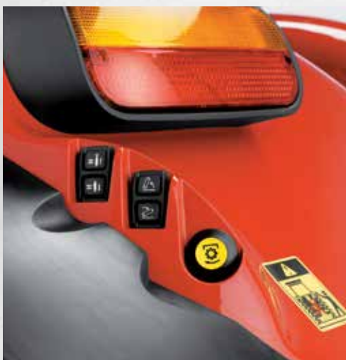
Außenbetätigung für Heckzapfwelle, Hubwerk und ein Steuergerät an beiden Heckkotflügeln.
