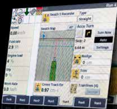
S-Turn II wendet automatisch am Ende der Fahrspur
