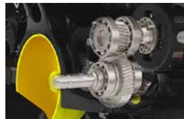
Direkte Kraftübertragung vom Motor zum Frontzapfwellengetriebe
