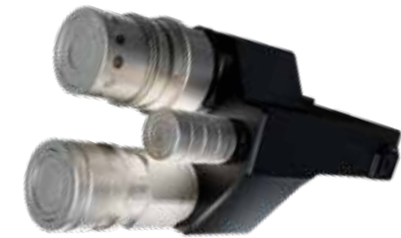
Ölmotoren oder hydraulisch anspruchsvolle Anbaugeräte können über den Power Beyond Anschluss mit bis zu 110 l Öl pro Minute gespeist werden.
