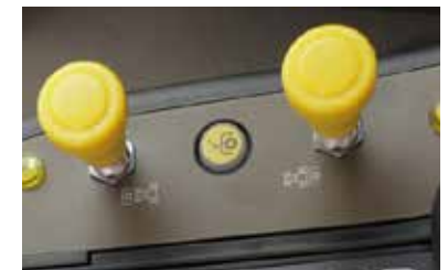
Elektrohydraulische Aktivierung der Heck- und Frontzapfwelle.
