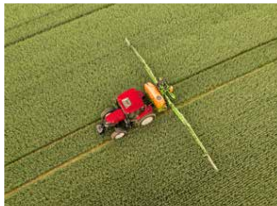
AFS AccuGuide: GPS- und Glonass-basierte Spurführung
