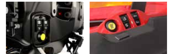
Externe Betätigung des Krafthebers, der Zapfwelle und eines Zusatzsteuergerätes sowohl an der Traktorfront als auch am Traktorheck.
