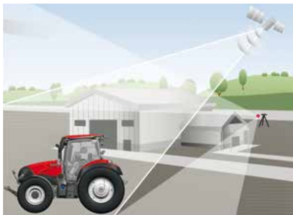
xFill überbrückt RTK+ Signalausfälle von bis zu 20 Minuten
