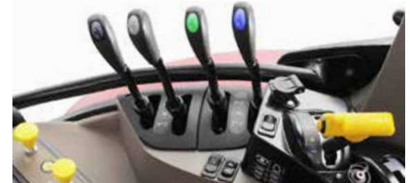
Bei der Ausführung mit rein mechanischen Hecksteuergeräten sind diese über ergonomische Hebel komfortabel zu bedienen.
