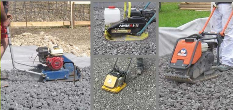
leichte Vibrations-Platte mit starkem Vortrieb
